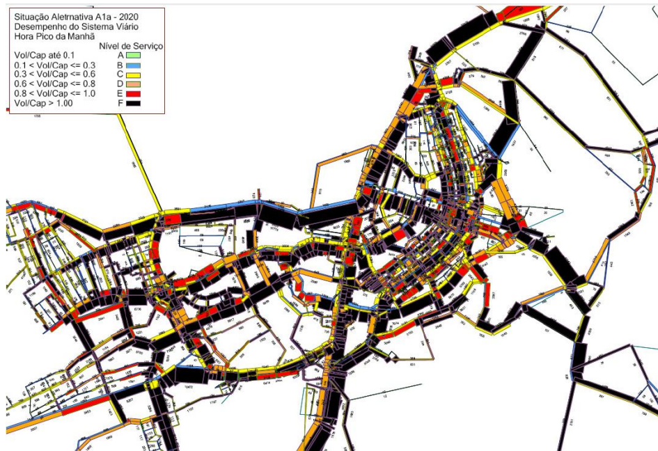
Figura 3. Carregamento do sistema viário com implantação da alternativa recomendada pelo PDTU, situação prevista para 2020. Em preto os piores níveis de serviço. Fonte: (DISTRITO FEDERAL, 2010, P. 164).
